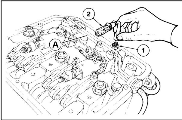
**STATIC INJECTION TEST INSTRUMENTATION- EARLY UNIT INJECTORS**
