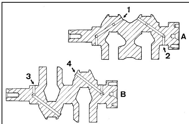
**CRANKSHAFT LUBRICATION DRILLINGS- TYPICAL**
