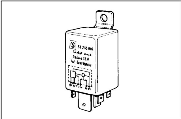
**GLOW PLUG CONTROLLER / RELAY WITH COOLANT TEMP. SENSOR**
