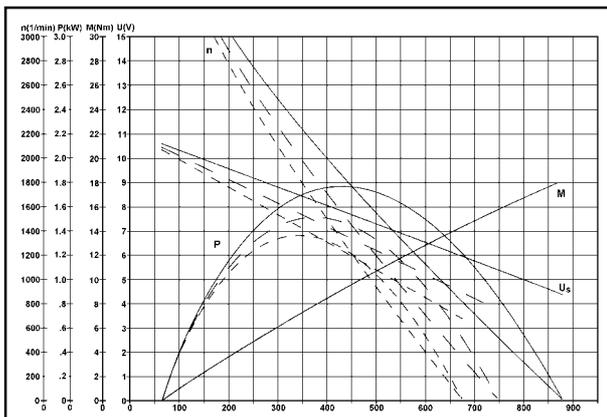
**PERFORMANCE CURVE- BOSCH 12V / 1.6KW (DW 12V) STARTER**
