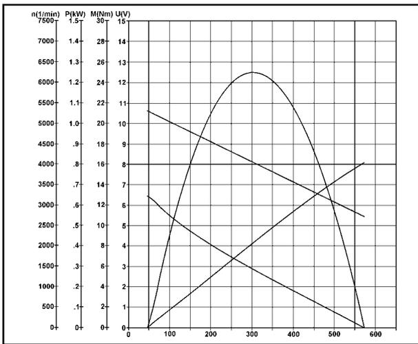
**PERFORMANCE CURVE- BOSCH 12V / 1.1KW (DW 12V) STARTER**
