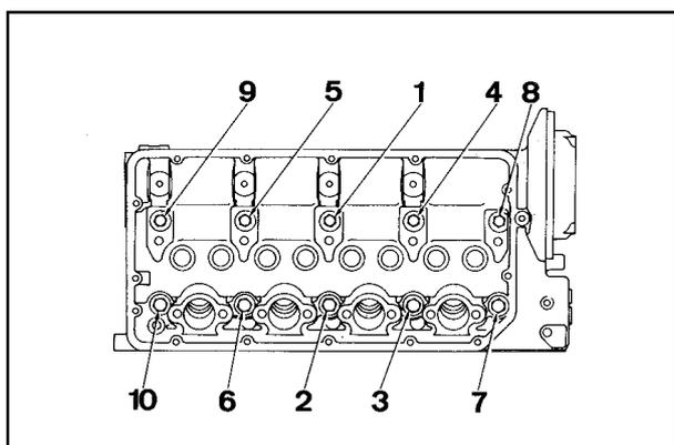
**CYLINDER HEAD TIGHTENING PROCEDURE- LDW 1204, LDW 1404, LDW 1204/T**
